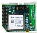
Comunicatore GSM/GPRS, invio e ricezione SMS, Invio e ricezione chiamate vocali, comunicazione con centrali di vigilanza (SIA, Contact ID, SIA IP...), permette la connessione con l'App BW e il JCI PowerManage
