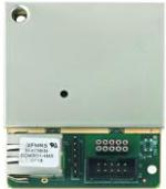
Scheda IP per comunicazione con centrali di vigilanza (SIA, Contact ID, SIA IP.), permette connessione con APP e JCI PowerManage, non richiede configurazione sul router o indirizzo IP fisso
