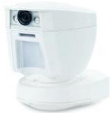
Rilevatore di movimento PIR a specchio da esterno con antimascheramento attivo e telecamera incorporata. Tecnologia «Octa Quad» per una immunità totale alle fonti di falso allarme. Totalmente configurabile dalla centrale, senza la necessità di riaprire il sensore una volta chiuso, Cattura istantanea dell'immagine- inizia a registrare non appena l'allarme è attivato, Immagini a colori e in alta risoluzione, nessuna area "persa" quando la camera scatta la foto, Design anti-vandalismo
